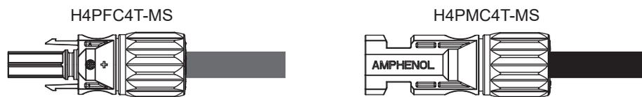
(1) 正極および負極ケーブルの保護被覆と芯線の絶縁被覆を剥がします。(6.5 ~ 7.5mm)
