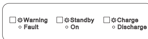
図③【蓄電池ユニット 動作表示 LED】
